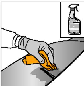
Um sicherzustellen, dass der Klebstoff auf der Oberfläche und nicht auf Staubpartikeln haftet, ist eine saubere, staubfreie Oberfläche Grundvoraussetzung für jede Klebeanwendung.
