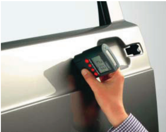
Messung der Lackdicke auf Stahlblech mit magnetinduktivem Verfahren
