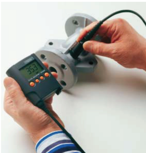
Teile mit komplexer Geometrie misst man idealerweise mit einem MPOR-PP
