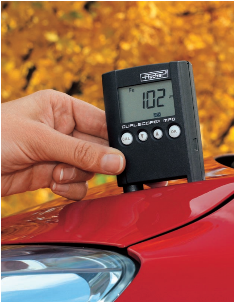
Kontrolle der Lackschichtdicke mit dem DUALSCOPE® MPO z. B. für Gutachten im Karosseriebereich
