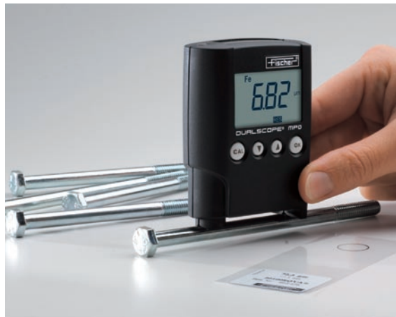
Messung von Zink auf Eisen. Bei stark gekrümmten Messobjekten ist eine Kalibrierung zwingend notwendig, um richtige Messwerte zu erhalten
